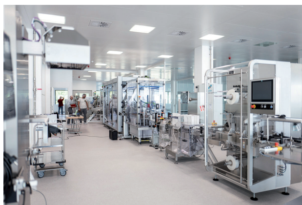
Reinraum Eschbach – Aufbau der 6-bahnigen, ersten Stickslinie.
